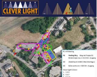
Rad- und Gehwege, usw. Die LED Leuchten werden auf eine sehr geringe eingestellt. Grundhelligkeit Passieren jedoch Fußgänger, Zweirad- oder Autofahrer die Straße, werden sie von den Leuchten den an angebrachten Sensoren erfasst. Beleuchtung verstärkt sich automatisch und fährt in das zuvor programmierte Beleuchtungsniveau hoch. Das Signal wird an die nächste Leuchte per
