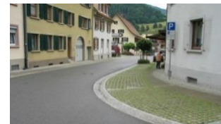
Abb. 6 Geteerte Straße und Stellplätze mit begrüntem Fugenpflaster. Fließende Übergänge durch den systematischen Verzicht auf Bordsteinkanten. Die Begrünung wurde bereits bei der Planung angedacht und kann abgemäht werden.
